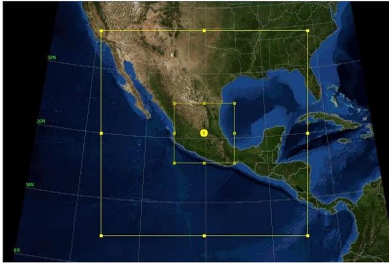
Figure 3. Representación de los dominios 9x9 y 3x3 km simulados mediante WRFv3.9 sobre México. Fuente: Autores
