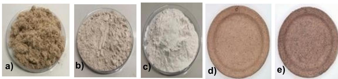
Figura 1. contenedores biodegradables obtenidos a base de agro-residuos de la cuenca del Papaloapan. a) fibras de psudotallo de plátano, b) almidón de plátano macho, c) almidón de papa, d) contenedor control, e) contenedor con fibra pretratada
