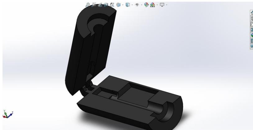
Figura 5. Carcasa abierta en forma de bisagra mostrando cavidades para elementos electrónicos.
